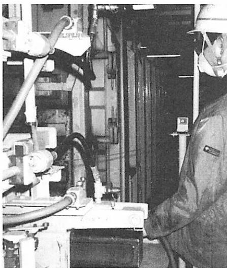
杉並中継所地下2階で行われているプラスチックごみなどの圧縮工程で、ごみを詰め込んだ大型コンテナを圧縮装置から切り離すところ。圧縮工程で毒性化学物質が発生、「大気汚染を考える会」が問題にしている。11月27日、川名英之写真。
