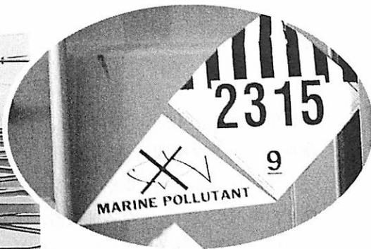
横浜ノースドックへ搬入されるPCB入りコンテナ。トラックには、PCBを示すラベル（クラス9、その他危険物質）と海洋汚染物質であることを示すラベルが添付されている（拡大写真上）。このラベルは、最初に搬出された時には添付されていなかった。今回、日本で大きな騒ぎとなったため、新たに付けられた。
