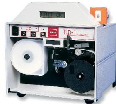
ChemKey TLD(米国製)という有毒ガスを扱う職場で使用される有害ガスモニターを使用。紙テープに特定のガスのみ反応する薬品が染み込ませてあり、漏れた有毒ガスに反応して色が変わると共に、光学的に読み取りアラームを鳴らす。
