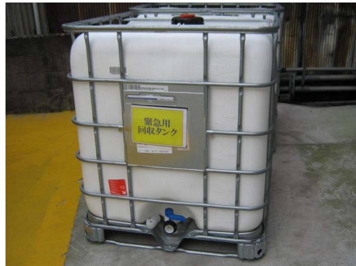
緊急用回収タンク
